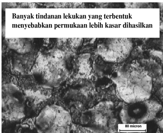
Rajah 3 : Topografi permukaan keluli terkeras H13 bagi proses EDM yang menggunakan elektrod grafit dan keadaan pemotongan, I_p = 2A , T_i = 12\mu s , T_o = 1\mu s
